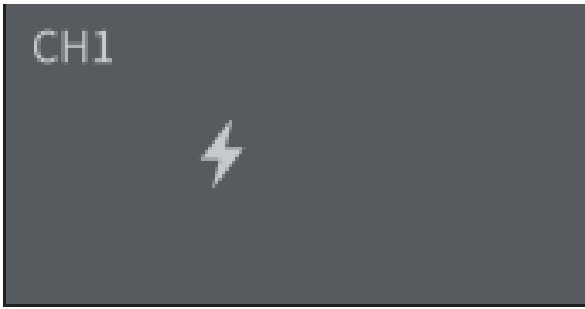
Не исправен аккумулятор - разъем CH1
