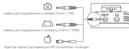
**Примечание:** При использовании внешнего микрофона подключайте его правильно. Поддерживаются только микрофоны с разъемом TRS.
