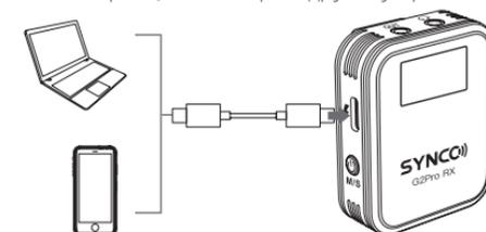
**\*Примечание.** При подключении к компьютеру в настройках звука установите для входного микрофона значение SYNCO G2Pro. Для устройства вывода звука - SYNCO G2 Pro, чтобы использовать режим мониторинга в реальном времени.
